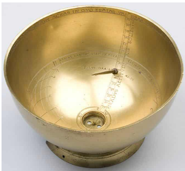
FIGURE 4 – Coupe à réfraction en laiton de Georg Hartmann datée de 1548 (Collection of Historical Scientific Instruments, Department of the History of Science, Université d'Harvard). Une boussole située au fond de la coupe permet l'orientation vers le Nord. La pointe du gnomon doit être immergée pour que l'ombre tombe sur le tracé fermé des lignes d'heures et des arcs diurnes.
